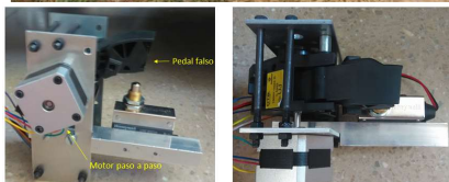
Estructura del pedal falso para aceleración, vista lateral y vista cenital
